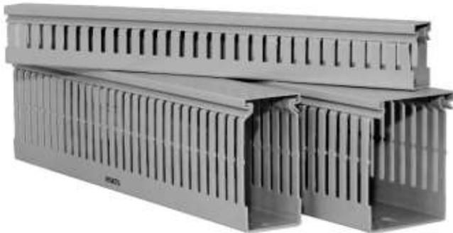
Excelentes características de seguridad contra incendios. Los bordes lisos y sin rebabas protegen a los instaladores de lesiones y los cables de daños. Las costillas se pueden quitar fácilmente gracias a los escorzos superiores. Los bordes inferiores en la base de la pared lateral permiten cortar y quitar secciones de la pared lateral sin bordes afilados.
