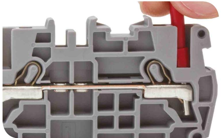
Los cables sólidos y flexibles (con ferrules) se conectan a el borne solo con presionar (pushin) el cable, sin la necesidad de un destornillador. El diseño patentado de este muelle resorte proporciona una conexión rápida y segura en ambientes con fuertes vibraciones.
